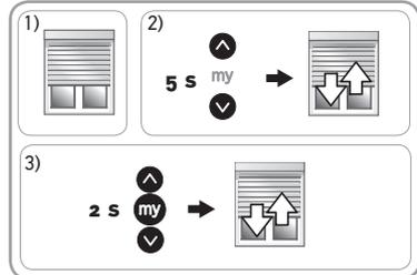
3) **Drücken Sie gleichzeitig s 2 s lang die Tasten  $\blacktriangle$ , my und  $\blacktriangledown$ , bis der Rollladen mit einer kurzen Auf-/Abbewegung bestätigt:**
