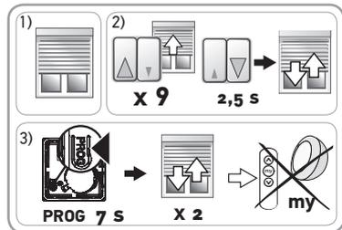
3) Drücken Sie ≈ 7 s lang die PROG-Taste des lokalen Somfy io-homecontrol®-Funksenders, bis der Rollladen mit zwei kurzen Auf-/Abbewegungen bestätigt:
