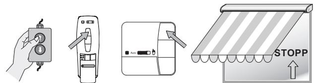
6. Drücken Sie solange die **AUF**-Taste, bis der Antrieb automatisch stoppt.
