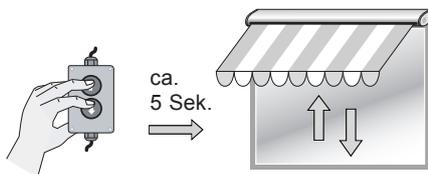
3. Drücken Sie **gleichzeitig** beide Tasten am Montagekabel.
