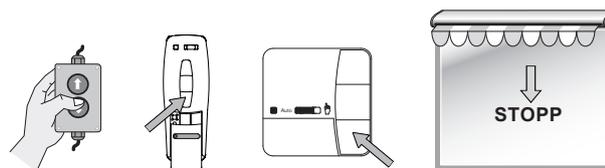
3. Drücken Sie solange die **AB**-Taste, bis der Antrieb automatisch stoppt.
