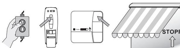
6. Drücken Sie solange die **AUF**-Taste, bis der Antrieb automatisch stoppt.
