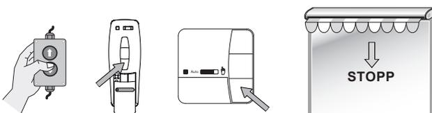
3. Drücken Sie solange die **AB**-Taste, bis der Antrieb automatisch stoppt.
