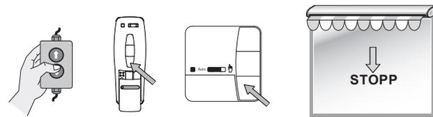
3. Drücken Sie solange die **AB**-Taste, bis der Antrieb automa-
