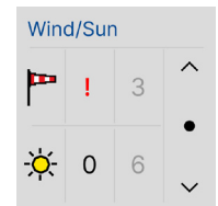
Ansicht Kabelbruch / Verlust der Sensorik
