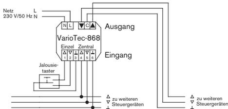
Fig. 4 Anschluss als Gruppensteuergerät
