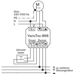
Fig. 3 Anschluss als Antriebssteuergerät
