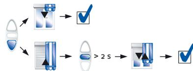
Prüfen Sie die Drehrichtung durch kurzes drücken von **AB**. Führt die Markise in die **AB-Richtung** ist die Drehrichtung richtig eingestellt. Führt die Markise in die **AUF-Richtung** müssen Sie die Drehrichtung ändern. Drücken Sie zum ändern der Drehrichtung **STOP**, bis der Antrieb mit einer kurzen **AUF-/AB-Bewegung** bestätigt.
