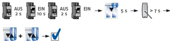
Schalten Sie die Netzspannung für **2 sec. aus**, dann wieder für **10 sec. ein**, nochmals **2 sec. aus** und anschließend wieder **ein**. Der Antrieb bestätigt mit einer **5 sec.-Bewegung**. Drücken Sie nun die **PROG**rammiertaste so lange, bis der Antrieb das Rücksetzen **zweimal** mit einer kurzen **AUF-/AB-Bewegung** bestätigt.
