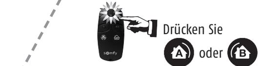
... Piep..., Piep... der Zentrale. Außerdem **blinkt die Kontrolllampe zur Bestätigung der korrekten Übermittlung zweimal grün.**
